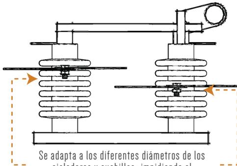
Se adapta a los diferentes diámetros de los aisladores y cuchillas, impidiendo el desprendimiento del disco.
